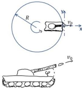
טנק נמצא בקצה של דיסקה ברדיוס R היכולה להסתובב במקביל לקרקע. הדיסקה מתחילה להסתובב ב- $t=0$  בתאוצה זוויתית  $\ddot{\theta} = kt^2$ . כעבור זמן  $t_0$  הטנק נמצא במיקום שבאיור ויורה פגז. מהירות הלוע של הפגז היא  $v_0$ .
