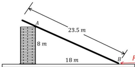
קצה הקורה מונח על הרצפה בנקודה B במרחק  $18\text{m}$  מהקיר ובקצה הזה פועל כוח אופקי  $F$ , כמתואר באיור.
